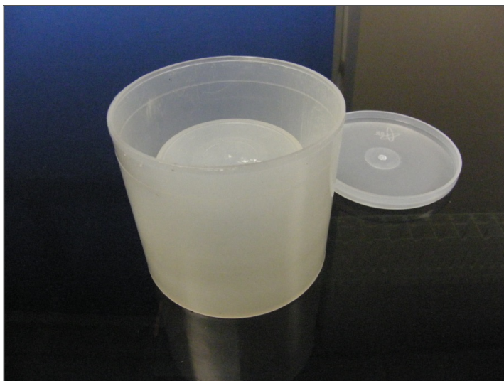
Pojemnik pomiarowy typu Marinelli (450 cm 3 ).
